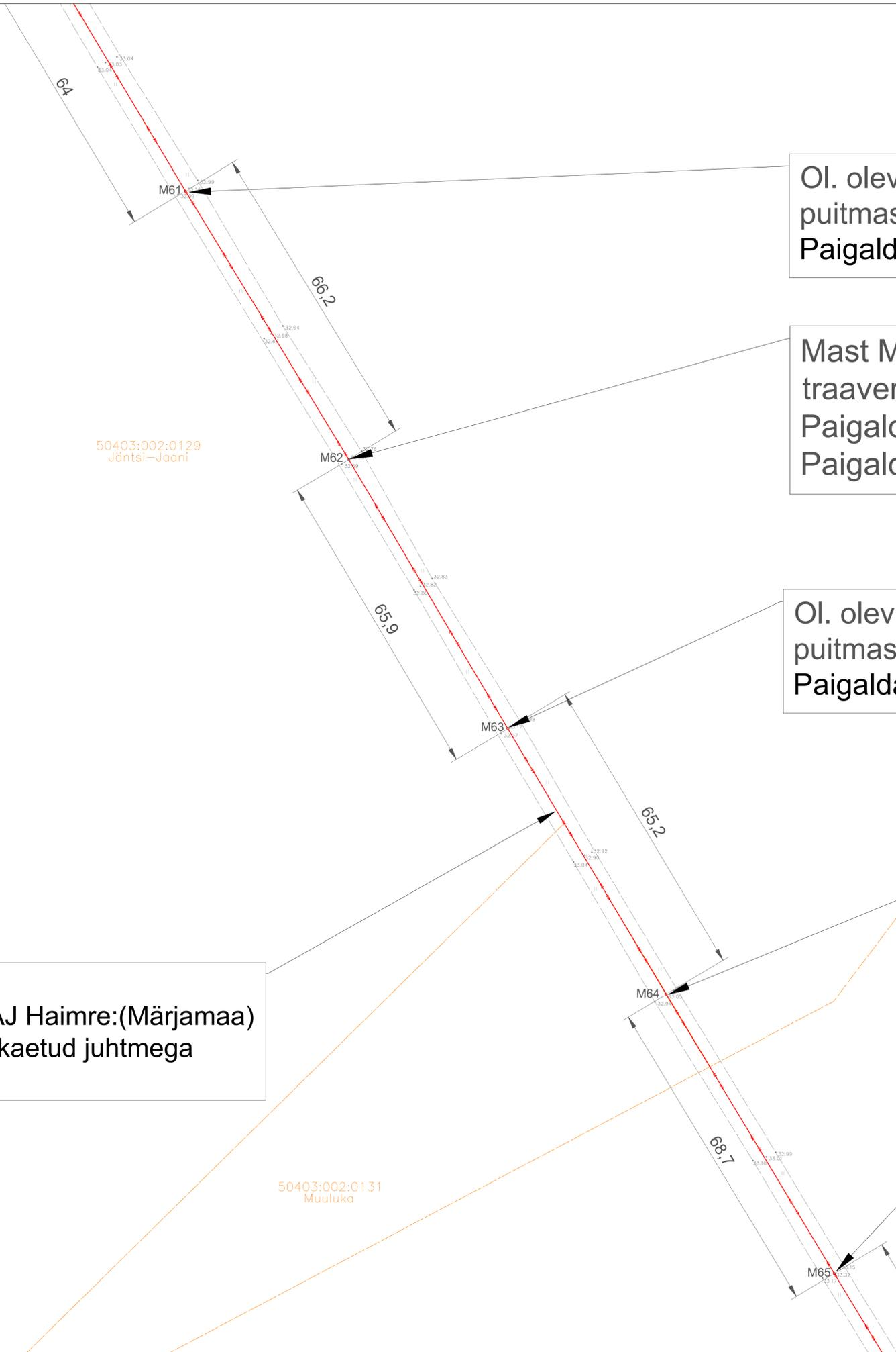
Oi. olev mast M61 asendada puitmastiga - 11m, III klass, kreosoot. Paigaldada kandetraavers, isolaatorid.
